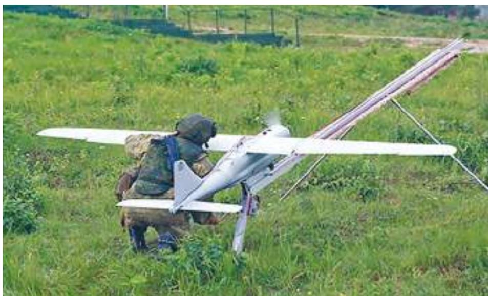
**Рис. 3. БПЛА «Орлан-10» на стартовой позиции**
