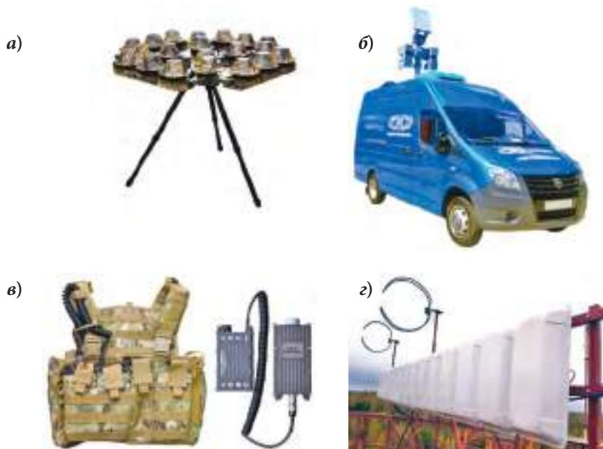
Рис. 8. а) многофункциональный мобильный комплекс обнаружения и радиоэлектронного подавления БПЛА «Сапсан-бекас»; б) переносной (стационарный) комплекс противодействия БПЛА «Купол-про»; в) портативная система подавления спутниковых навигационных систем «Zala-zont»; г) система обнаружения и противодействия БПЛА «Эгида»
