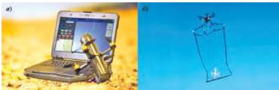
Рис. 2. а) БПЛА-камикадзе *DroneBullet* канадской *AerialX*, б) БПЛА-перехватчик с сетью
