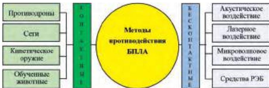
Рис. 1. Методы противодействия БПЛА
