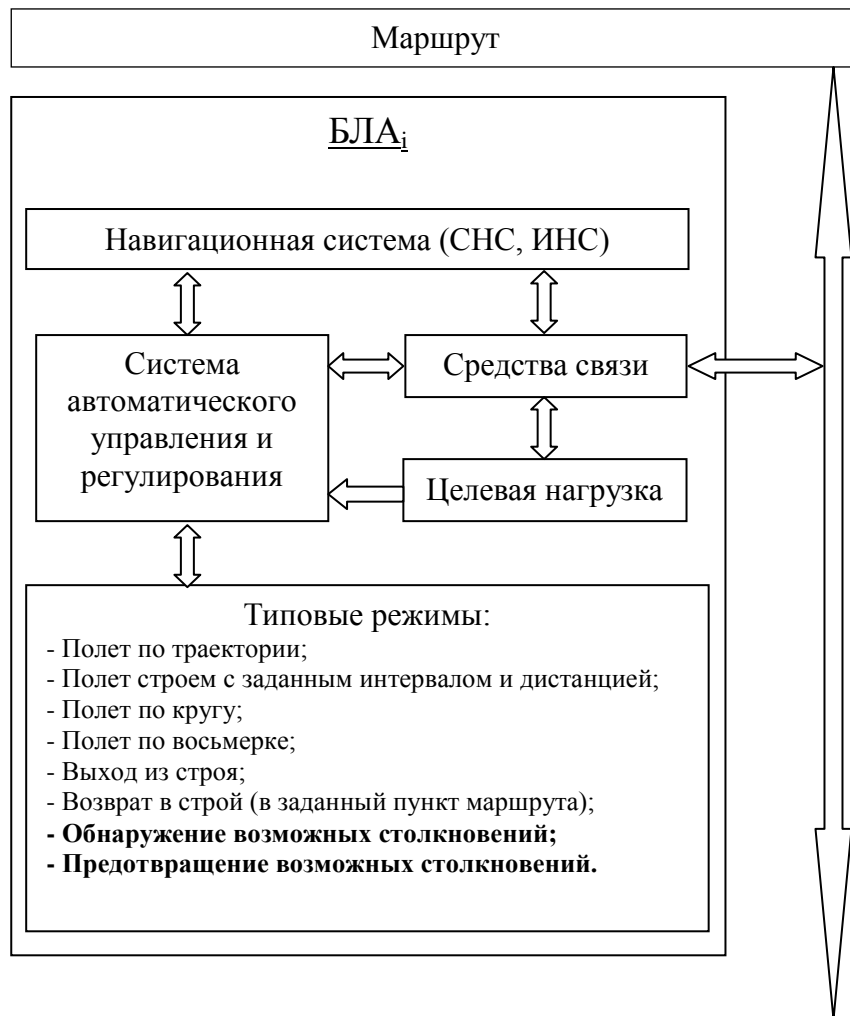
Рисунок 4. Структура бортового оборудования БЛА
