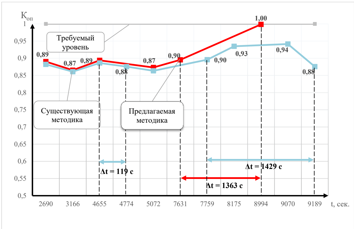
Рис. 2. Зависимость между коэффициентом оперативности и временем выполнения полетного задания без влияния ИТВ
