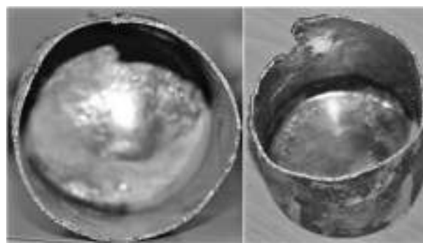
Рис. 6. Результат эксперимента. Остаток заготовки из ВТ6 диаметром 60 мм и высотой 100 мм. Стенка гарнисажа ~1,5 мм
