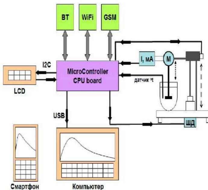
Комплекс предназначен для измерения динамической вязкости жидких топлив и иных гомогенных жидких сред (биодизель, смесевые топливные композиции и др.). Замеры выполняются полуавтоматически с отображением результатов измерений в режиме реального времени.
