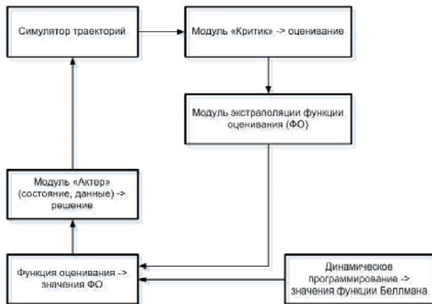
Рис. 2. Комбинированная схема формирования функции оценивания
