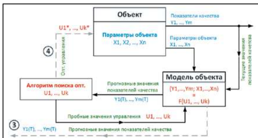
Рис. 7. Схема прогнозирования (3) и управления (4) по модели объекта
