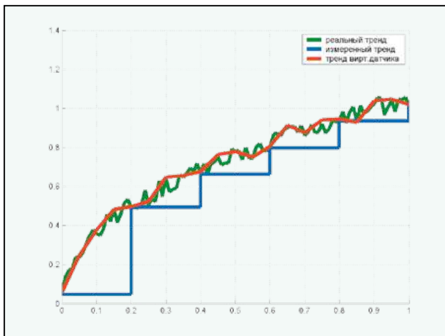
Рис. 6. Пример работы виртуального датчика
