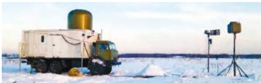
Рис. 7. Радиолокационно-оптический комплекс обеспечения безопасности объектов и нейтрализации БПЛА «Валдай»
