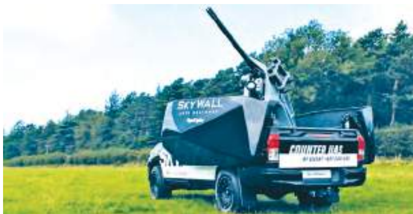
Рис. 4. Система SkyWall Auto Response для запуска снаряда с сетью
