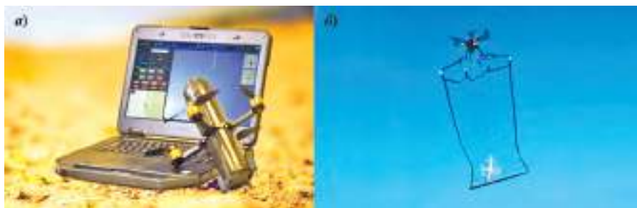
Рис. 2. а) БПЛА-камикадзе DroneBullet канадской AerialX , б) БПЛА-перехватчик с сетью
