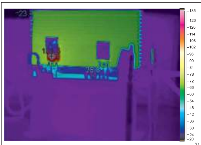
Рис. 14. Тепловой профиль при полной нагрузке IGW40N120H3 на частоте 20 кГц
