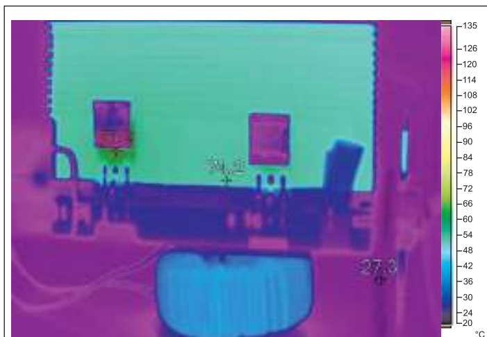
Рис. 13. Тепловой профиль при полной нагрузке C2M0080120D на частоте 100 кГц
