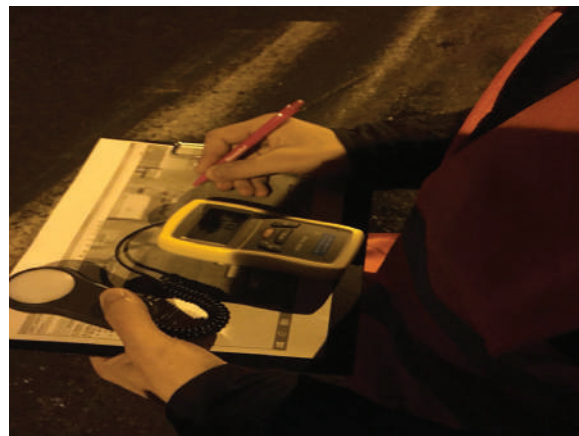
Рисунок 1 – Проведение измерения освещенности с помощью люксметра «Victor 1010A»
