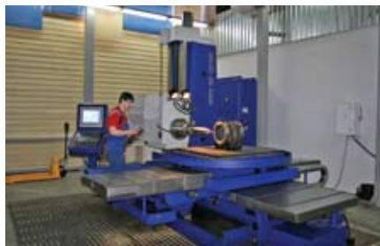
Базирование заготовки на горизонтально-расточном станке
