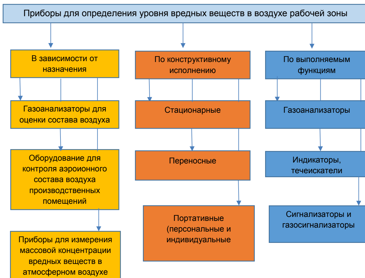
Рисунок 1 – Классификация приборов для определения уровня вредных веществ в воздухе рабочей зоны
