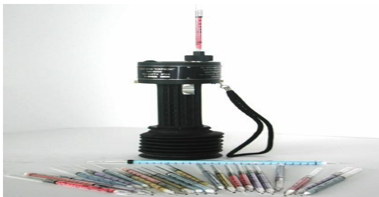
Рисунок 3 – Общий вид аспиратора АМ 0059
