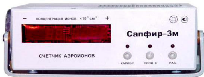
Рисунок 9 – Общий вид измерителя аэроионов Сапфир-3М
