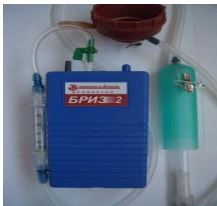
Рисунок 4 – Общий вид аспиратора Бриз – 2
