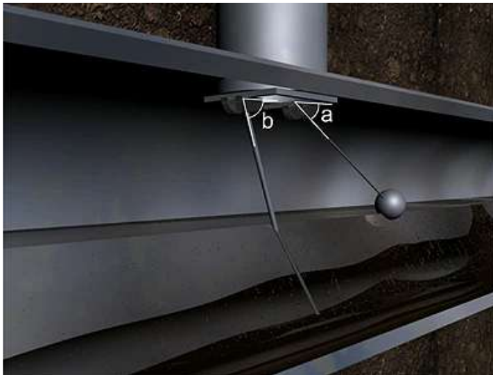
Рис. 5. Рычажно-маятниковый расходомер безнапорных потоков «СТРИМ». Через значение угла (а) определяется уровень жидкости в потоке, а через значение угла (b) – скорость потока.
