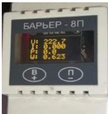
Рисунок 2. WEB-монитор в корпусе от реле напряжения «Барьер»
