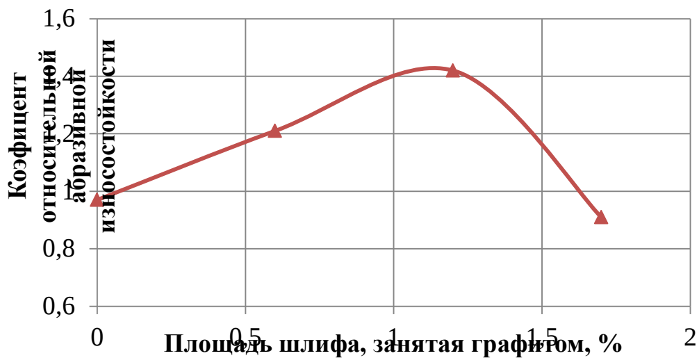
Рисунок 7. Влияние количества шаровидного графита на коэффициент относительной абразивной износостойкости образцов из среднелегированного хромоникелевого чугуна по сравнению с закаленным чугуном типа «Нихард-4»
