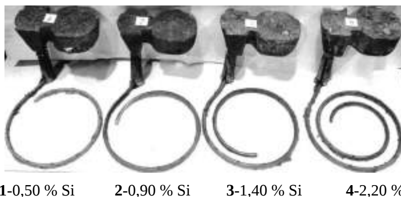
Рисунок 3. Зависимость жидкотекучести разработанного среднелегированного хромоникелевого чугуна от содержания кремния при температуре заливки 1350 °C
