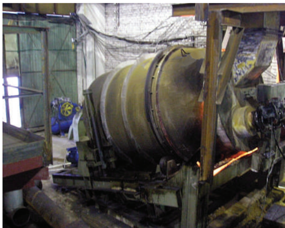
Рис. 1. Ротационная печь для получения свинца из шламов
