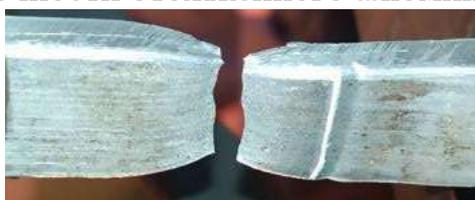
Рисунок 3 – Сваренный образец после испытания на растяжение
