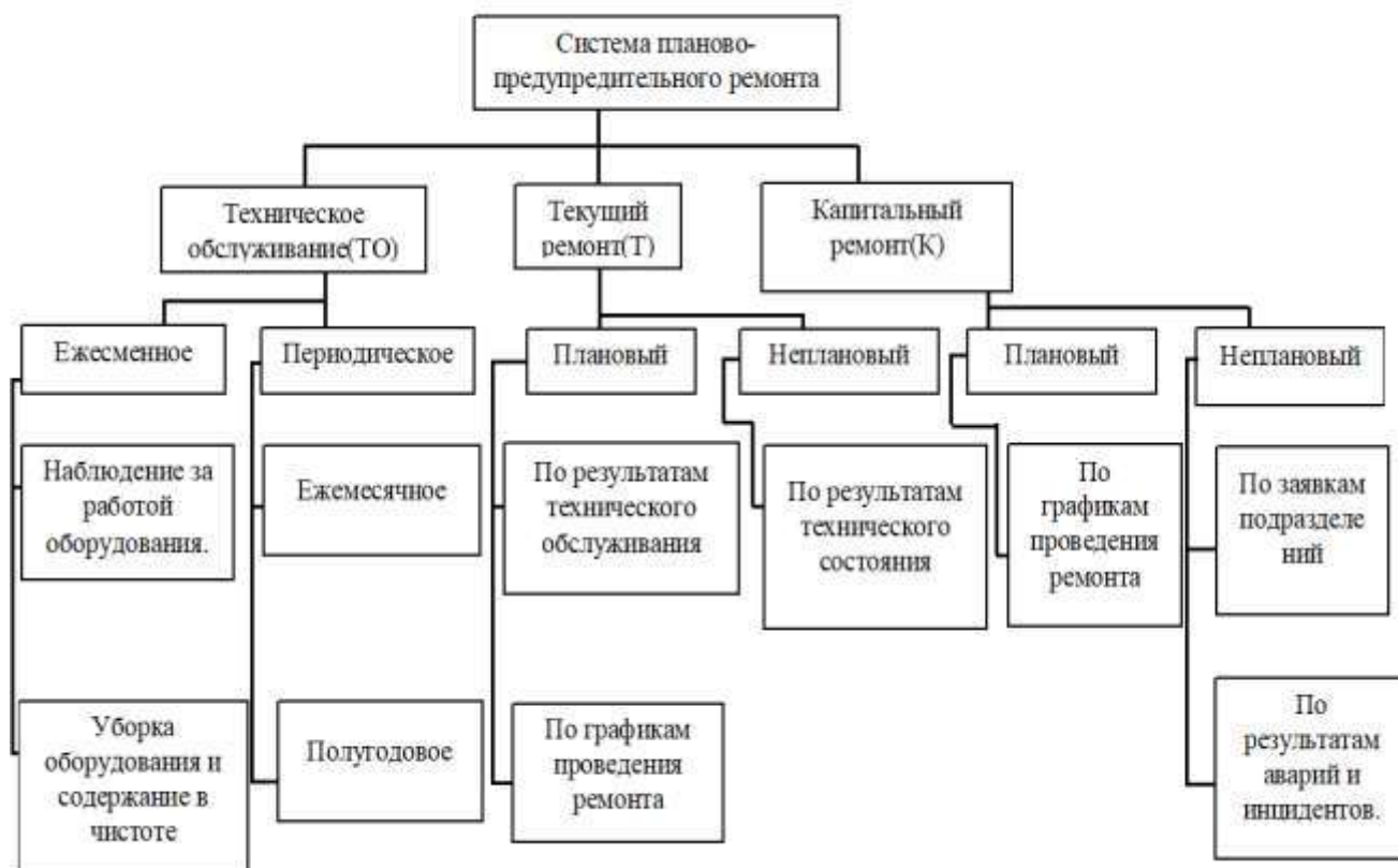
Рисунок 1 – Система планово-предупредительного ремонта
