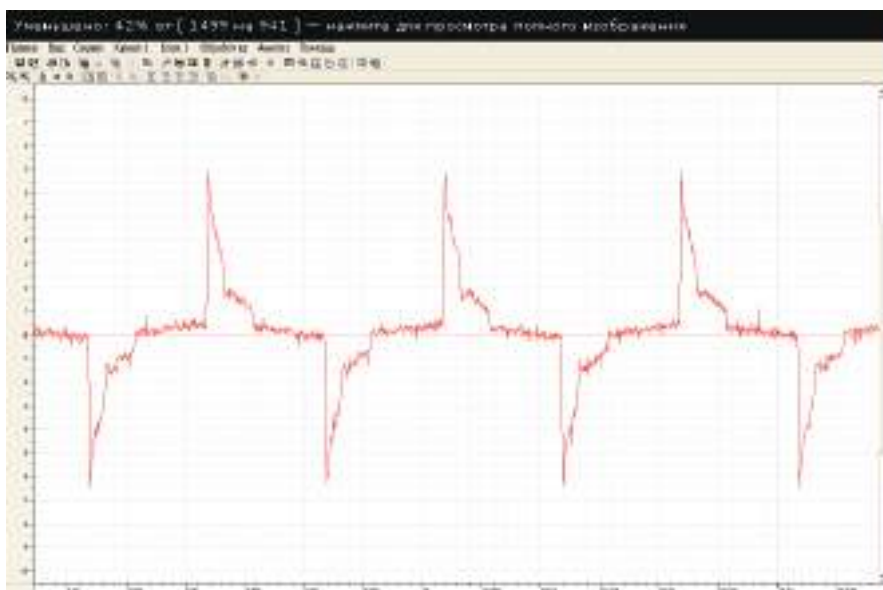
Рис. 1. Осциллограмма тока при подключении трех CFL
