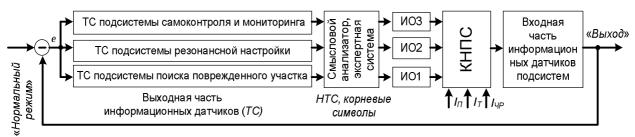
Примечание,  $I_{\mathit{UP}}$  — сигнал частичных разрядов,  $I_{\mathit{\Pi}}$  — сигнал помех,  $I_{\mathit{T}}$  — сигнал технологических процессов электросети
